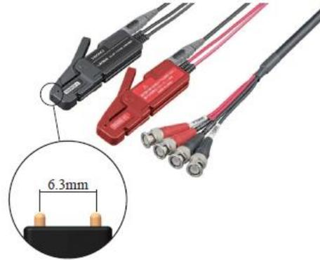
圖例 13: 新開發的夾式測量探針間距相隔甚遠，保持恆定的距離
