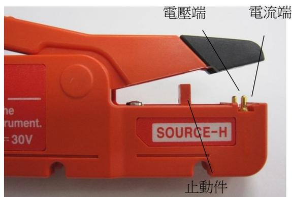
圖例 16: 新開發的探測器提供基於接觸點和電壓和電流端子間的距離不變
