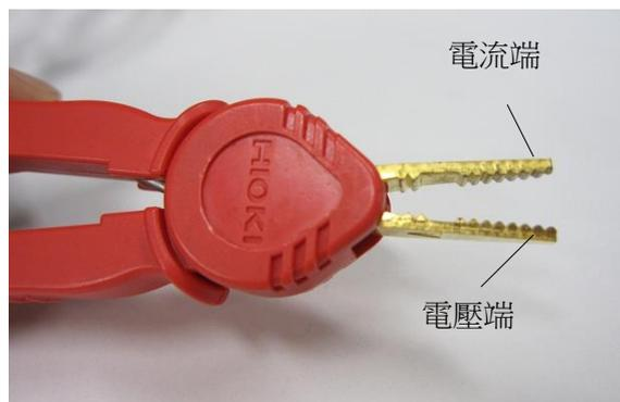
圖例 15: 傳統的電壓和電流測量端兩側皆被靠近間隔排列，並具有多點接觸
